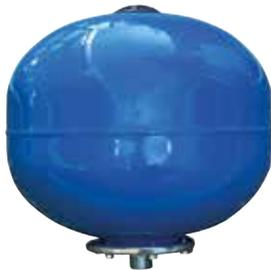
Serbatoi a membrana intercambiabile. Adatto ad installazioni dirette sulla pompa. Fornito con membrana in EPDM. Temperatura max di esercizio di +99°C. Pressione di esercizio max 8 bar. Pressione di precarica 1,5 bar.
