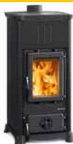
Focolare in ghisa - Porte, telaio, basamento e testata in ghisa smaltata - Cassetto cenere estraibile - Aria primaria e secondaria regolabile per migliore gestione combustione - Sistema di post-combustione per basse emissioni - Vetro ceramico - Rivestimento in acciaio - Rendimento 88,7% - Peso Netto 121 kg - Scarico fumi Ø120 mm S - Consumo orario 1,7 kg/h - Classe Energetica A+
