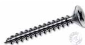
Testa cava croce - Vite in acciaio inox austenitico A2, per l'avvitamento senza preforo su: legni duri in ambienti umidi e marini - Trattamento di passivazione - Lubrificazione Lubex
