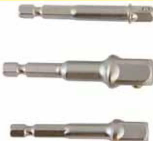
Serie di 3 adattatori per bussole 1/4" - 3/8" - 1/2" - Attacco avvitatore da 1/4" - Lunghezza adattatore 1/4": 65 mm - Lunghezza adattatore 1/2": 75 mm - Lunghezza adattatore 3/8": 65 mm
