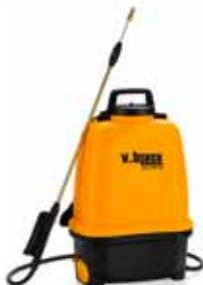
Con batteria al litio ricaricabile V.BATTERY - Pressione max 5 bar - Guarnizioni in NBR - Scheda elettronica con controllo di tensione che mantiene costante la pressione per tutta la durata della batteria - Schienale imbottito - Materiale serbatoio: Polipropilene - Carica batteria - Canna in alluminio / ottone telescopica - Ugello in ottone regolabile per irrorazione - Spallacci imbottiti e regolabili - Possibilità di utilizzo sia a destra che a sinistra (pompa ambidestra)
