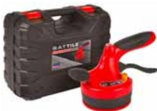
Ventosa battente per piastrelle e lastre in ceramica, gres porcellanato, granito, marmo e vetro - Alimentata con batterie agli ioni di litio - Compatta e leggera e permette il posizionamento tramite ventosa e la successiva vibrazione per eliminare eventuali bolle d'aria - L'intensità della vibrazione è regolabile da 5.000 a 18.000 vibrazioni/minuto tramite un potenziometro posto in prossimità dell'impugnatura - Peso: 950 gr.
