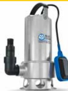
Pompa ad immersione progettata per acque sporche - Per aspirare acque scure da stagni, pozzetti, fosse, cisterne e scavi presenti all'interno di cantieri edili assicurando elevate prestazioni - Profondità max 7 mt - Altezza max 10,5 mt - Corpo in acciaio inox - Dimensioni particelle max 35 mm - Diametro uscita: 25 mm (1"), 32 mm (1"1/4), 38 mm (1"1/2) - Peso: 6,6 kg - Resistenza all'acqua IPX8
