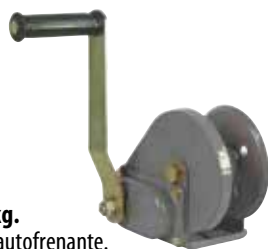
MAURER argano a manovella Portata orizz./vert. 1150/345 kg. Acciaio alta resistenza. Sistema autofrenante. Tamburo Ø 83 mm. Fune Ø 8 mm. cod. 91352
