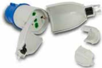
Convertispina OPTIMUS industriale 1 spina 2P+T 16A 200-250V - presa bipasso 2P+T 16A Grado di protezione IP44 - Costruiti in riferimento alla normative CEI EN 50250 e CEI EN 60309-1/2 - Particolarmente adatti per il camping, giardinaggio, per l'allacciamento di attrezzi ed elettro-utensili in genere, in luoghi dove la presa disponibile sia diversa dalla spina montata sull'apparecchio utilizzatore
