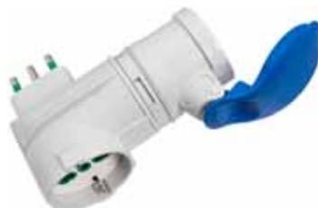
Adattatore industriale DUPLEX 1 spina 16A 230V 2P+T - 1 presa Bipasso 2P+T 16A - 1 presa 2P+T 16A 200-250V Grado di protezione IP44 - Costruiti in riferimento alle normative CEI EN 50250 e CEI EN 60309-1/2 - Particolarmente adatti per il camping, giardinaggio, per l'allacciamento di attrezzi ed elettro-utensili in genere, in luoghi dove la presa disponibile sia diversa dalla spina montata sull'apparecchio utilizzatore
