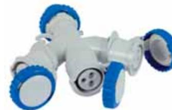
Adattatore industriale 1 spina 16A 200-250V 2P+T - 3 prese 16A 200-250V 2P+T - Grado di protezione IP 67 - Costruiti in riferimento alle normative CEI EN 50250 e CEI EN 60309-1/2. - Particolarmente adatti per il cantiere, camping, giardinaggio, per l'allacciamento di attrezzi ed elettro-utensili in genere - Cavo HQ7RN-F (Neoprene) da 3 m Sez. 3G2,5 mm<sup>2</sup>
