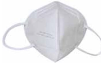
Tessuto ecologico - Polipropilene Melt-Brown - Occhielli elasticizzati - Banda nasale in alluminio - Filtrazione polveri fini PM 2,5 - Confezionate in singole buste sigillate - Qualità certificata CE 2163 - Standard EN149: 2001 + A1: 2009 FFP2 NR - Non medicale
