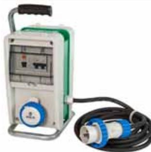
Quadro EOLO ASC IP65 con cavalletto, cavo 4 mt 3G2,5 H07RN-F- 1 spina 2P+T 16A 200-250V 6h IP67- Prese: 3 x 2P+T 16A 200-250V 6h IP67 - Protezioni: 1 interruttore magnetotermico 2P 16A C-1 - Interruttore differenziale 2P 25A 30mA AC - Potenza max 3 kW
