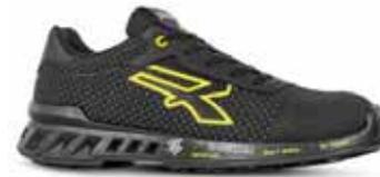
Leggere con puntale Airtoe® Aluminium e suola realizzata con un'innovativa miscela PU di nuova generazione - Tomaia in PUTEK® star altamente resistente all'abrasione, idrorepellente e traspirante - Protezione della punta con film anti-abrasione - Traspiranti con suola antiscivolo, antistatica, antiolio e anti-abrasione - Calzature di sicurezza in classe di protezione S3 SRC CI ESD con particolare protezione della suola dal freddo
