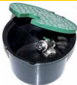
Pozzetto con valvola in metallo integrata attacco 3/4"- Altezza 13 cm - Doppio ingresso (inferiore + laterale)
