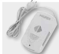
Rilevatore di metano, GPL, butan. Basso consumo di energia: <6W. Temperatura di utilizzo: -10°C +50°C. Umidità di utilizzo: 10%-85% RH. Livello di allarme: <=25% LEL. Intensità di allarme 85 db.
