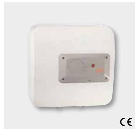
Tempi di riscaldamento estremamente rapidi e massima affidabilità. Dispositivo contro la sovra pressione idrica. Coibentati con schiuma di poliuretano espanso ecologica. Anodo in magnesio. Caldaia smaltata. Flangia a 4 bulloni. Termostato sicurezza. Pressione esercizio 8 bar. Direttiva ErP.
