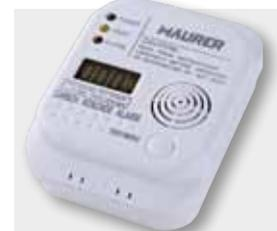
Sensore elettrochimico. Display digitale. Densità di monossido di carbonio e tempi di risposta allarme: 50 ppm 60-90 min.; 100 ppm 10-40 min.; >300 ppm in 3 min. Potenza allarme decibel: >85db/1 m. Norme: EN50291, ROHS
