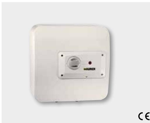
Anodo in magnesio di elevate dimensioni. Regolazione della temperatura con manopola frontale. Termostato per il controllo della temperatura immerso. Led resistenza in funzione. Accumulo smaltato. Resistenza elettrica in rame. Flangia di ispezione con 5 bulloni. Pressione massima esercizio 8 bar. By Ariston. IP X.
