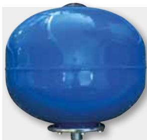
Serbatoi a membrana intercambiabile. Adatto ad installazioni dirette sulla pompa. Fornito con membrana in EPDM. Temperatura max di esercizio di +99°C. Pressione di esercizio max 8 bar. Pressione di precarica 1,5 bar.
