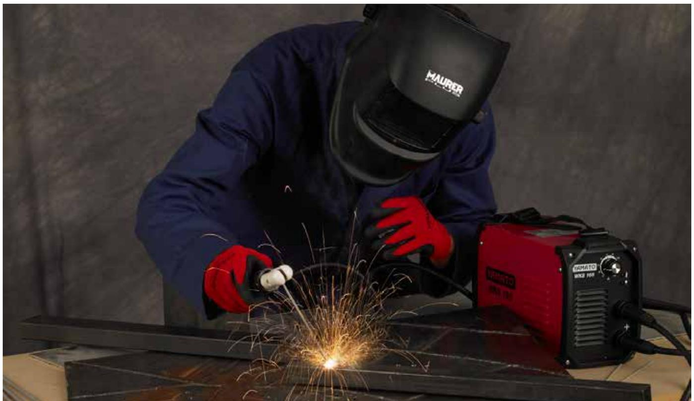
**ELMETTO AUTOSCURANTE PER SALDATURA**
