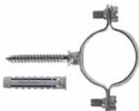
Collare distanziatore per tubi elettrici e tubi multistrato, in acciaio zincato con vite e tassello - Collarino con filettatura di attacco M 6 - Conf. in busta (completo di tassello SX6 e vite doppio filetto)
