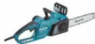
Barra da 35 cm e velocità della catena di 14,5 m/s. - Dotato di pompa dell'olio regolabile e regolazione della tensione senza attrezzi - Serbatoio olio catena 0,2 L - Velocità catena max (a vuoto) 14,5 m/s - Peso senza cavo 4,7 kg - Passo catena 3/8" - Spessore catena 1,1 mm - Cavo di alimentazione 0,3 m - Livello potenza sonora 100 dB(A) - Livello pressione sonora 89 dB(A)
