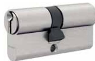
Doppio cilindro a chiave verticale: 6 perni, corpo in ottone finitura nichelata - Spine anti-trapano su corpo e barilotto, con resistenza fino 5 a minuti - Perna anti-bumping e anti-picking (i perni sagomati ostacolano la manomissione tramite chiave ad urto) - 3 chiavi in acciaio con collo lungo spessore 3 mm - Vite di fissaggio M5 mm inclusa
