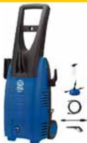
Carrello a 2 ruote completo di manico - Pompa a 3 pistoni assiali comandati dal piattello oscillante, testa alluminio - Pistoni in acciaio inox - Valvola di sicurezza automatica con azzeramento della pressione - Sistema di arresto totale dell'idropulitrice a distanza - Protezione termica del motore - Filtro acqua ispezionabile - Lunghezza cavo elettrico 5 mt - Dotazione: pistola, kit schiumogeno con serbatoio, lancia con getto regolabile, tubo AP 6 mt pvc, lancia con getto rotante, mini patio
